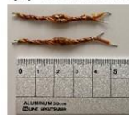
(d) Twisted shorter cable with 100 ohm damping
