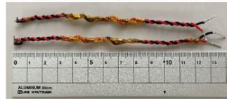
(d) Twisted shorter cable with 100 ohm damping
