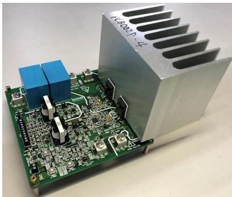
图 21. 散热器安装示例
