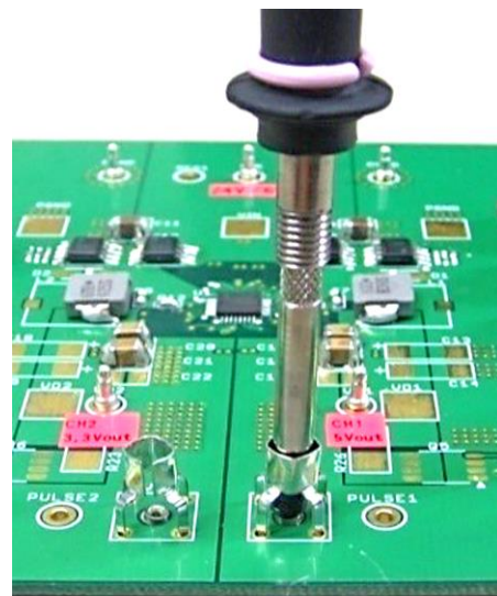
Figure 6. 使用探头尖端适配器来监测开关位置的状态
