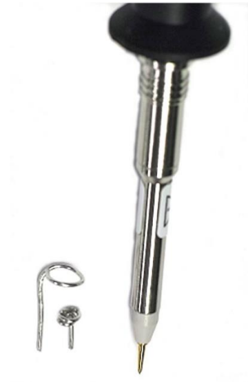
Figure 10. 作成的简易探头尖端适配器
