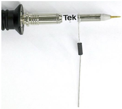
Figure 8. 制作适配器的接地支持部分
