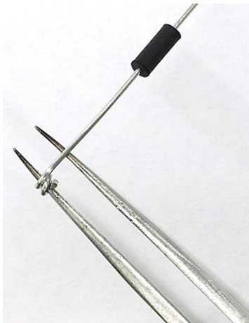
Figure 9. 制作适配器的尖端支持部分
